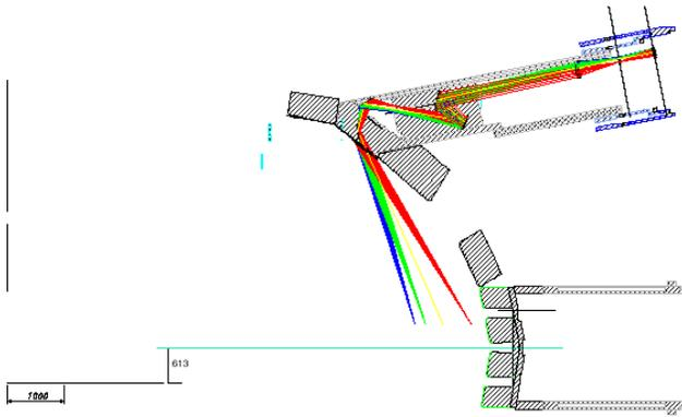
Figure 8.4 Edge CXRS optical system
