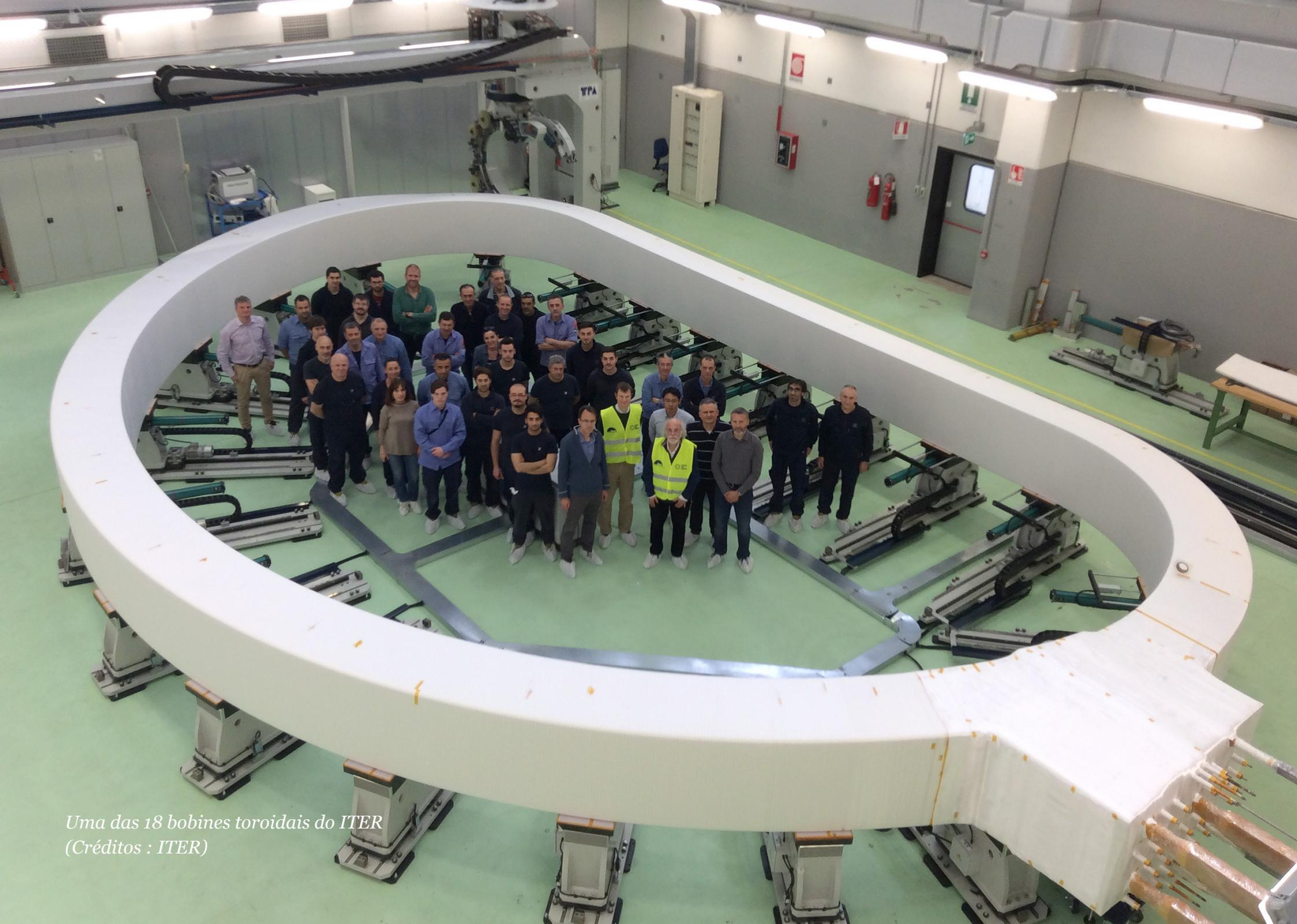
*Uma das 18 bobinas toroidais do ITER
