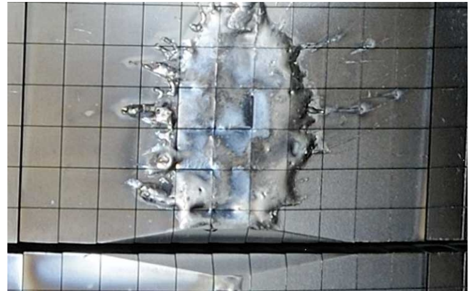
Telha de Berílio do JET derretida após experiências, devido a partículas rápidas do plasma que conseguiram escapar aos campos magnéticos que confinam o plasma(Créditos: UKAEA)
