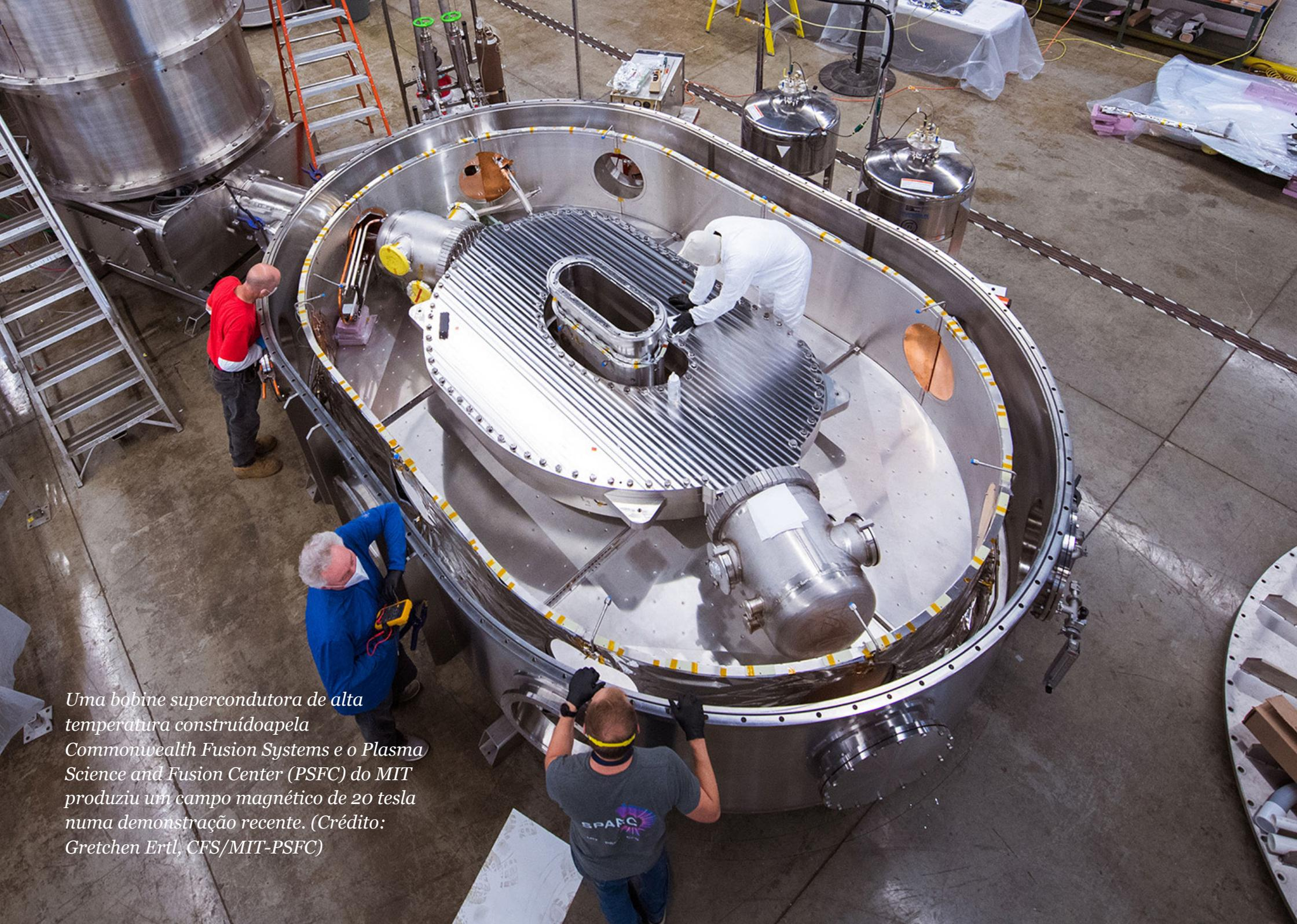
*Uma bobine supercondutora de alta temperatura construídoapela Commonwealth Fusion Systems e o Plasma Science and Fusion Center (PSFC) do MIT produziu um campo magnético de 20 tesla numa demonstração recente. (Crédito: Gretchen Ertl, CFS/MIT-PSFC)*
