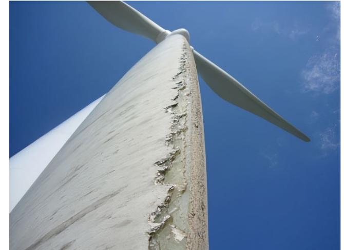
*A erosão do bordo de ataque da pá numa eólica offshore é enorme, e.g. um estudo\* estima que numa turbina de 4.2 MW com pás de 130-140 m corresponde a 62 kg/ano/turbina, outros estudos estimam valores das centenas de gramas por ano. Qual será o impacto de 10 GW offshore (o valor anunciado para Portugal) com a instalação de cerca 666 turbinas (se forem turbinas de de 15 MW)?*
