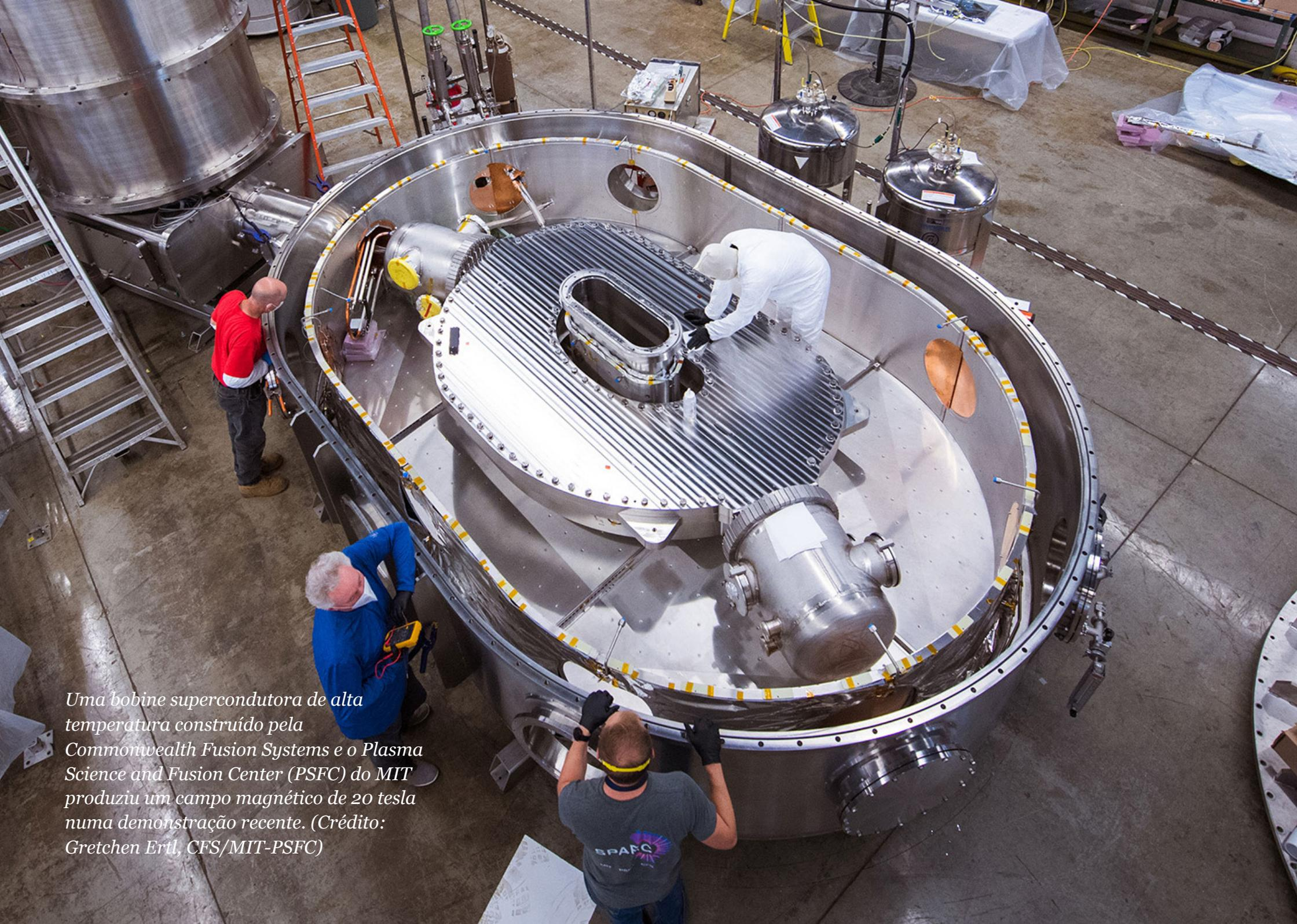
*Uma bobine supercondutora de alta temperatura construído pela Commonwealth Fusion Systems e o Plasma Science and Fusion Center (PSFC) do MIT produziu um campo magnético de 20 tesla numa demonstração recente. (Crédito: Gretchen Ertl, CFS/MIT-PSFC)*
